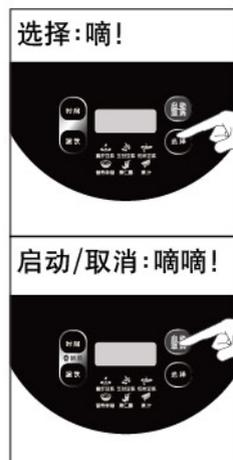
触按选择功能，对应的功能指示灯闪烁，并伴有“嘀”一声，触按“启动/取消”发出“嘀，嘀”启动功能，同时数码屏动态显示。
