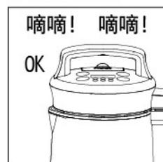
制浆完成后，发出“嘀，嘀……”声音，持续1min，功能指示灯闪烁，同时数码屏动态显示停止，即可断电，准备过滤饮用。
