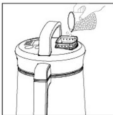
请把料斗放到机头上，用力向下按压料斗，使料斗通过周圈的条形卡筋固定在内腔上安装到位。将清洗干净的食材放入到机头料斗中（干豆放置在上层，大米放置在下层）
